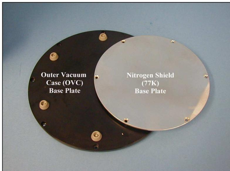
**Photo 1.3.** Cryostat base-plates
